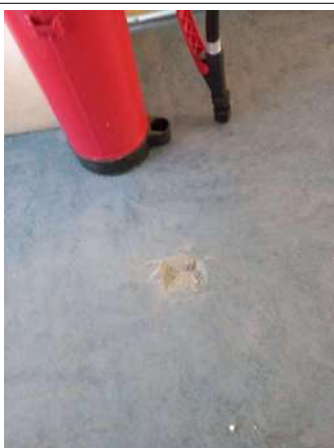
Prélèvement - P95 : R+2 / Dégagement 2 - Colle- (Présence d'amiante)
