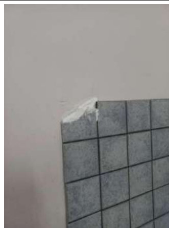
Prélèvement - P05 : R+0 / Tisanerie et vestiaires - Colle de faïence- (Absence d'amiante)
