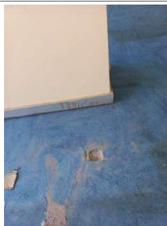
Prélèvement - P118 : R+2 / Bureau RAR 1 - Colle- (Présence d'amiante)
