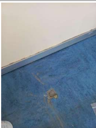
Prélèvement - P113 : R+2 / Bureau agent de service - Colle- (Présence d'amiante)
