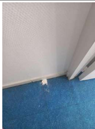
Prélèvement - P53 : R+2 / Sanitaires Femmes - Colle- (Présence d'amiante)
